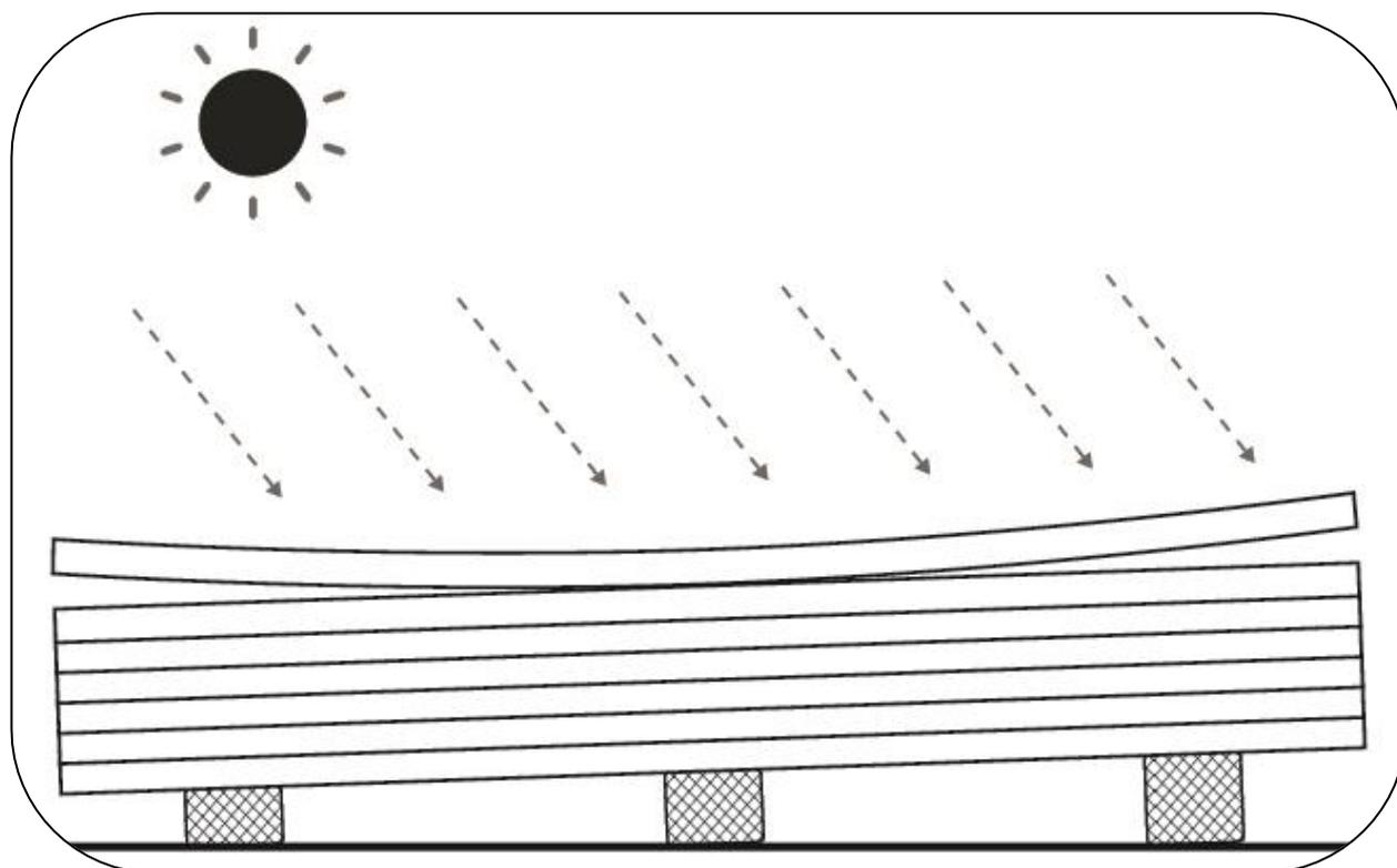
Nel caso di protezione a mezzo telone, occorre assicurare sia l'impermeabilità, che un'adeguata aerazione per evitare ristagni di condensa e la formazione di sacche di acqua.
