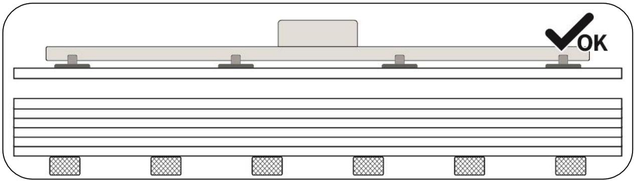
Lo studio e l'analisi dei sistemi a ventosa da impiegare è fondamentale per evitare di danneggiare i pannelli, per tanto si consiglia di progettare soluzioni adeguate confrontandosi anche con i fornitori dei sistemi in quanto esperti del settore. Una mancata progettazione del sistema di sollevamento può portare a rotture dei pannelli conseguenti all'imbarco degli stessi.
