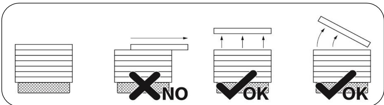
Attrezzature di presa, così come i guanti da lavoro, dovranno essere puliti e tali da non arrecare danni agli elementi. Si sconsiglia l'uso di carrelli elevatori per la movimentazione degli elementi, in quanto causa di danneggiamenti.
