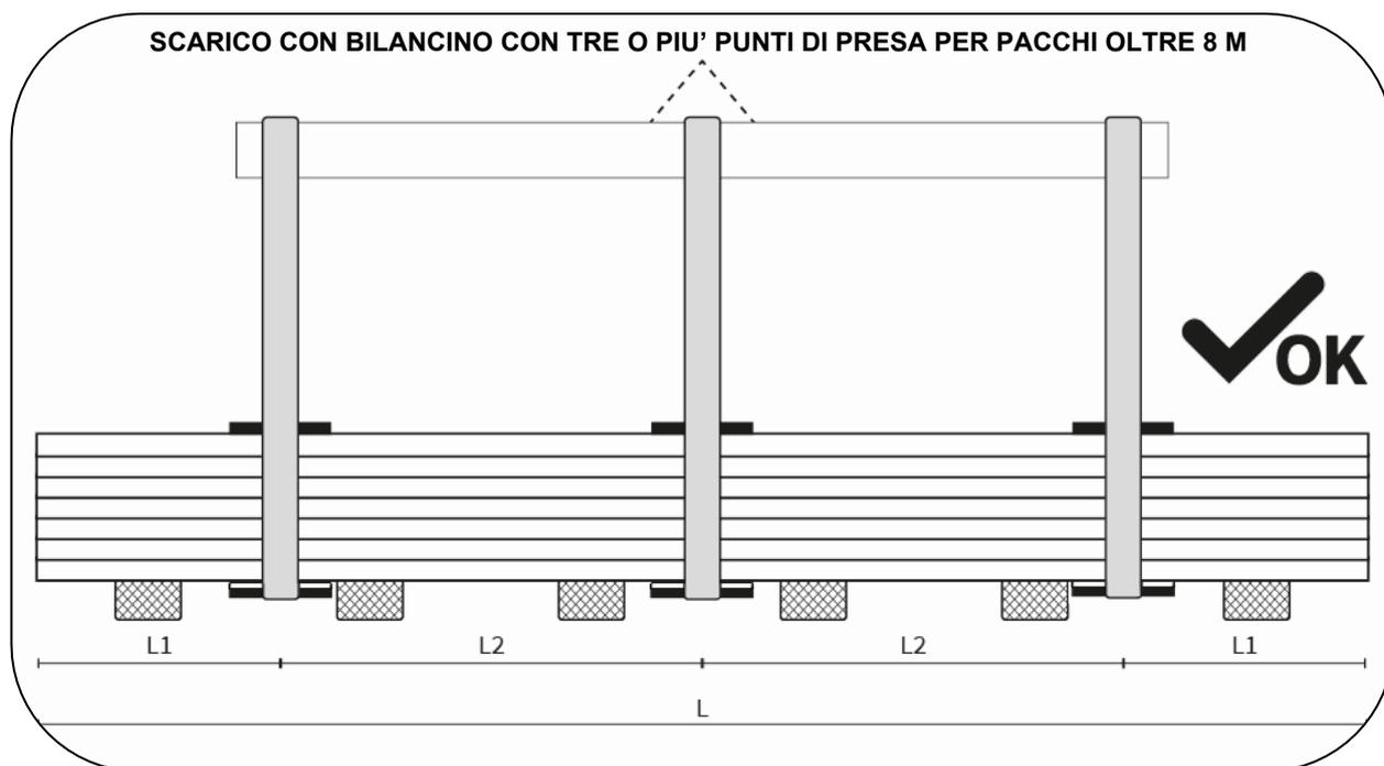
*La presa dei pacchi eseguita con modalità errate come l'impiego di mezzi di presa non corretti e/o dimensionati in modo errato oppure senza considerare la giusta distanza dei punti di presa può provocare alterazioni e conseguenti danni ai pannelli nel pacco.*
