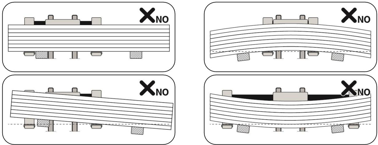
La movimentazione dei pannelli in cantiere deve essere eseguita con opportuni sistemi di sollevamento che siano stati adeguatamente progettati e dimensionati in modo da non provocare il danneggiamento del materiale in fase di montaggio.
